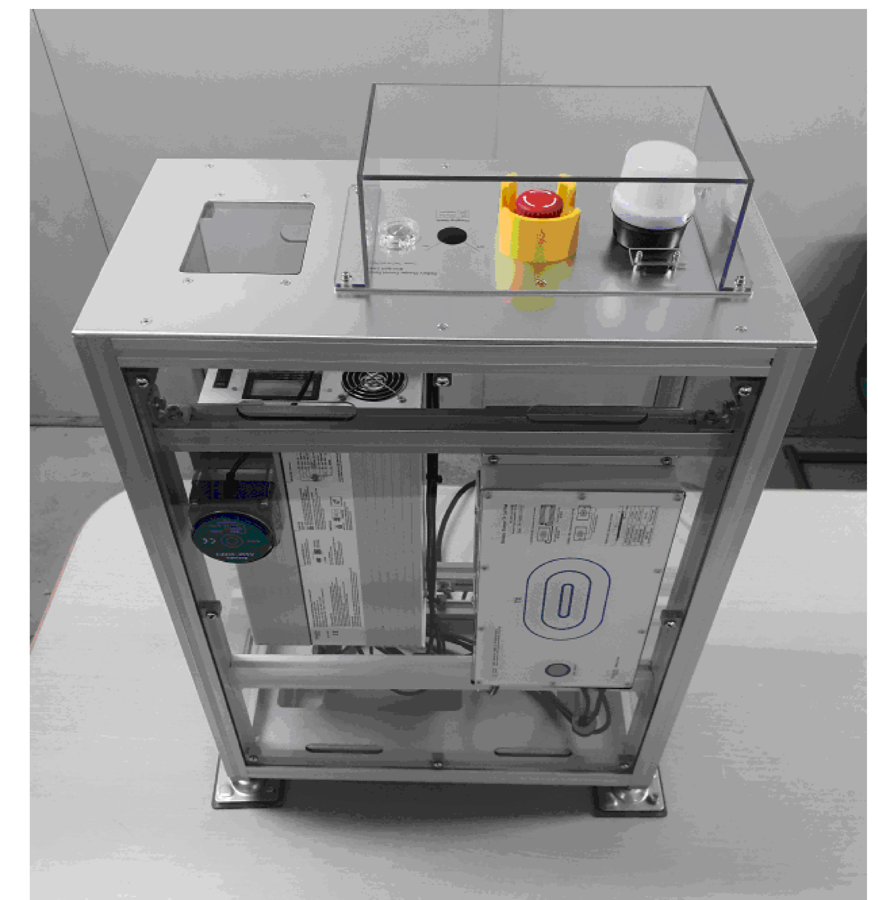
이 사진은 무선충전기에 적용된 사례이나, TC-3500W 무선충전기 가대(Fixture) 제작시 이를 응용할 수 있음.
