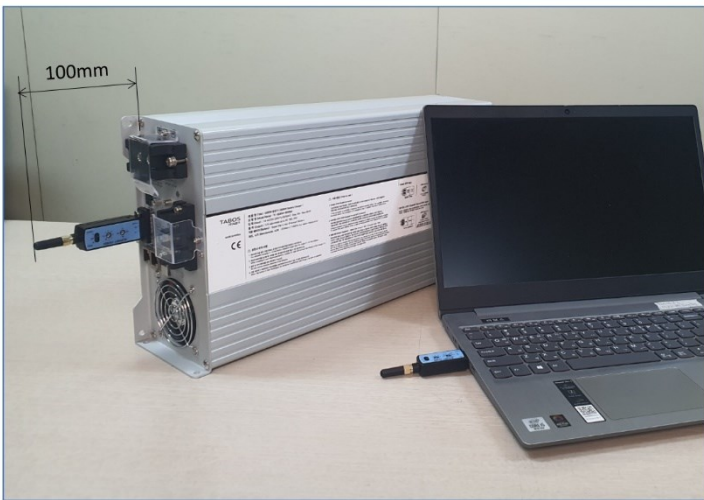
< 그림 3500W 충전기 무선통신모듈 장착 공간 >
