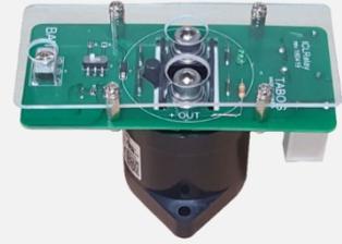
기능 : 리튬전지에 부하장치가 접속될 때 부하에 내장된 캐패시터가 배터리로부터 순간적인 과전류(Inrush Current)를 끌어 당겨 배터리가 과전류로 출력차단되는 것을 방지.
